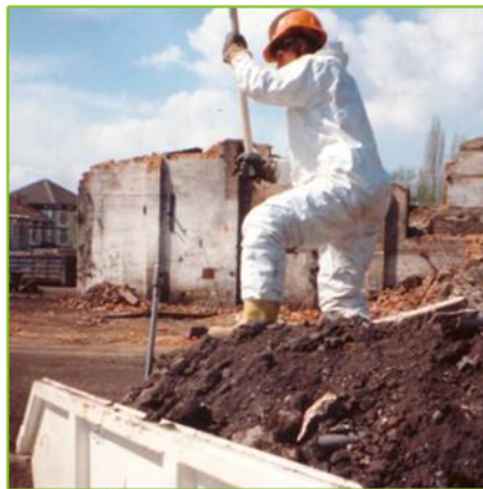
Beprobung von Bodenaushub in einem Container
