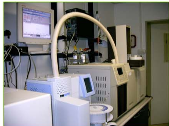
Thermodesorber/GC-MS – Kopplung zur Analyse von VOC in Raumluft
